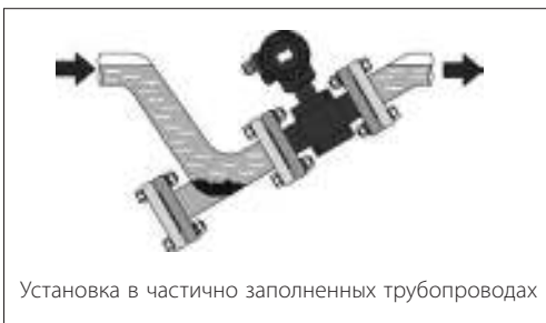
Расходомер устанавливается электронным блоком ВВЕРХ
